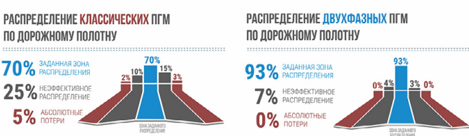
↑ Рис. 6 Равномерность распределения ПГМ в заданной зоне
