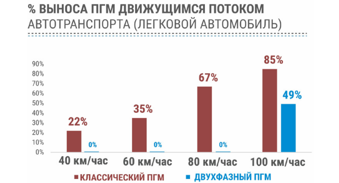
↑ Рис. 8 Доля выноса ПГМ за пределы тестовых участков турбулентными потоками от движущегося легкового автомобиля
